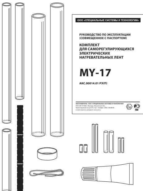
Комплект MY-17 предназначен для соединения высокотемпературных саморегулирующихся электрических нагревательных лент марок VC (свыше 125 °C) с оболочкой из фторопласта с максимальной температурой воздействия 190 °C. Комплект MY-17 включает в себя термоусаживаемые трубы на основе фторополимера, припой, медную плетенку, фоторадиостабилизированную ленту и клей-герметик.
