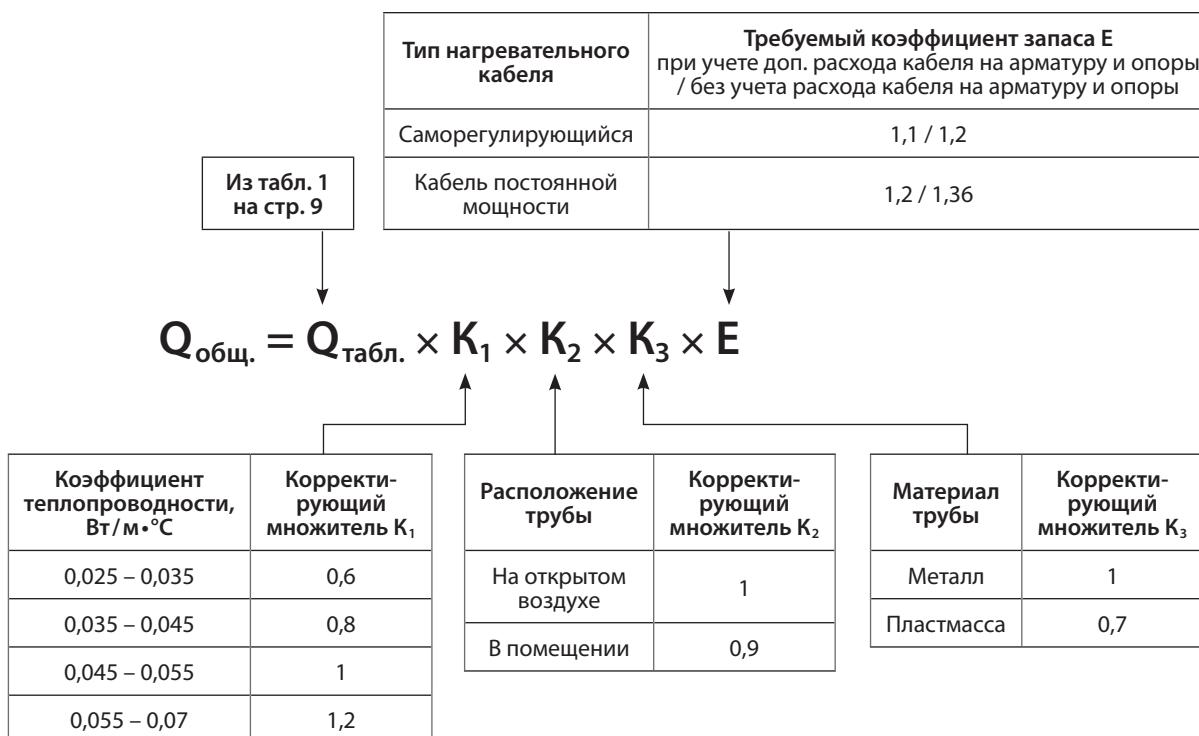
**3.** Также при выборе нагревательного кабеля необходимо учесть максимально допустимую температуру для данного кабеля, тепловыделение кабеля при поддерживаемой температуре, максимальную температуру поддержания для данного кабеля, корректирующий коэффициент напряжения питания, а также классификацию обогреваемой зоны и вероятность воздействия на кабель химически активных веществ (подробнее см. листы технической информации на конкретные кабели и аксессуары).
