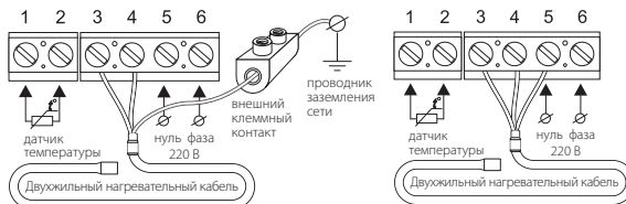
Схема подключения к 3-х проводной электрической сети
